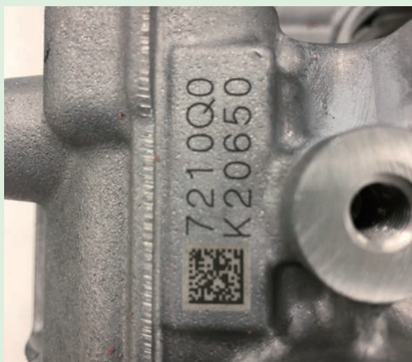
図2 2Dコードによるトラッキング
