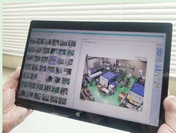
図1 稼働状況が見えるタブレット
