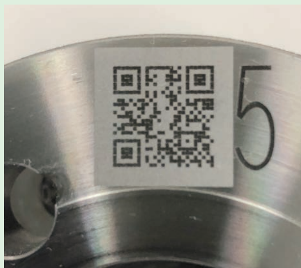
図2 2Dコードによるトラッキング
