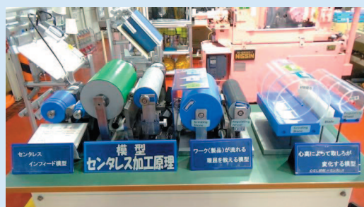
写真2：センタレス加工原理の模型
