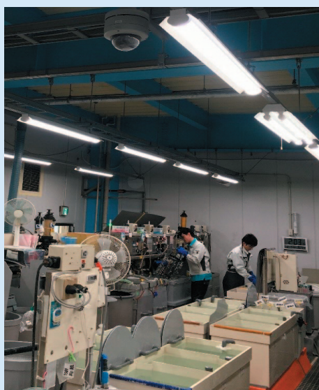
写真 1：めっき製造ラインでのめっき処理作業の様子
