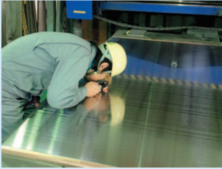
写真：連続鋳造用鋳型のめっき仕上げり状態の確認
