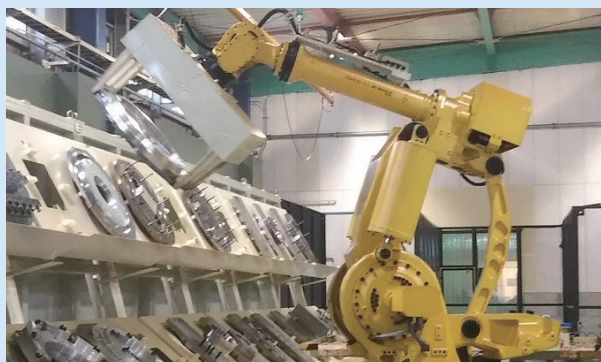
写真：全自動化された材料治具交換ロボット
