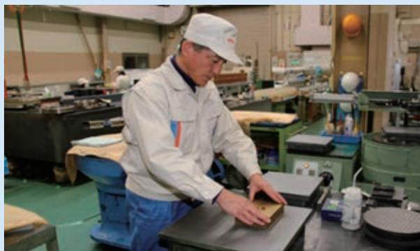
作業風景：高精度測長機部品のラップ仕上げ
