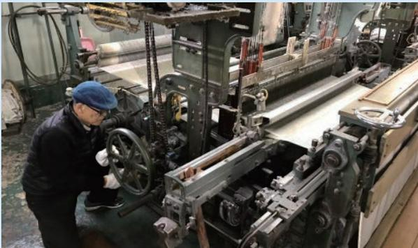
作業風景：織機によこ糸調整作業
