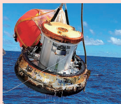
「こうのとりの」搭載小型回収カプセル 回収船に揚収されたカプセル (提供：JAXA)
