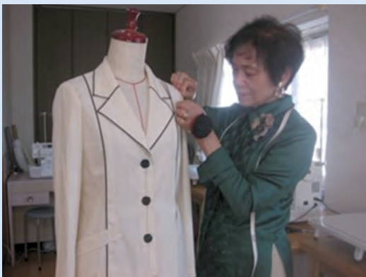
作業風景：シーチングによるジャケットの立体裁断
