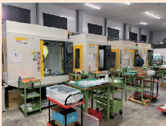
図 CNC 自動旋盤や小型立形マシニングセンタによる精密部品加工
