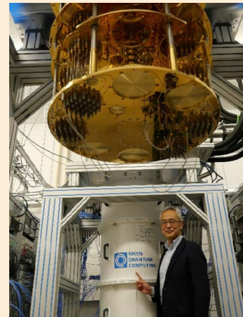
図7 ゲート方式の超電導量子コンピュータ評価システム(内部)
