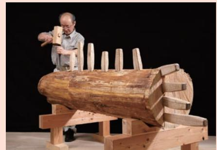
写真：古代の打割製材検証実験
