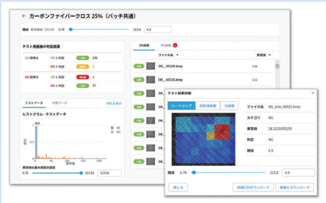
AdaInspector Cloudの検査実行後の出力イメージ (学習画像からの差異の大きさをヒートマップ表示)
