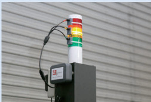
図1 IoTによる生産工程の見える化
