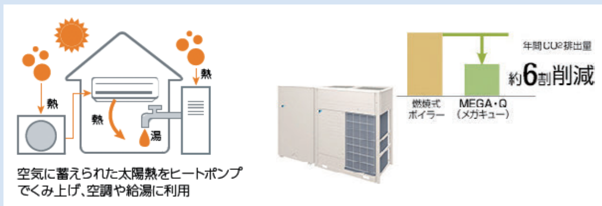
図2 ヒートポンプの仕組みと、大型業務用ヒートポンプ給湯システム「MEGA・Q（メガキュー）」年間CO 2 排出量比較
