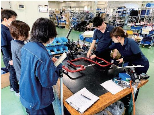
写真：オーダーメイド車椅子の組立工程確認
