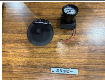
図2：加速度センサ付きスピード抑制機
