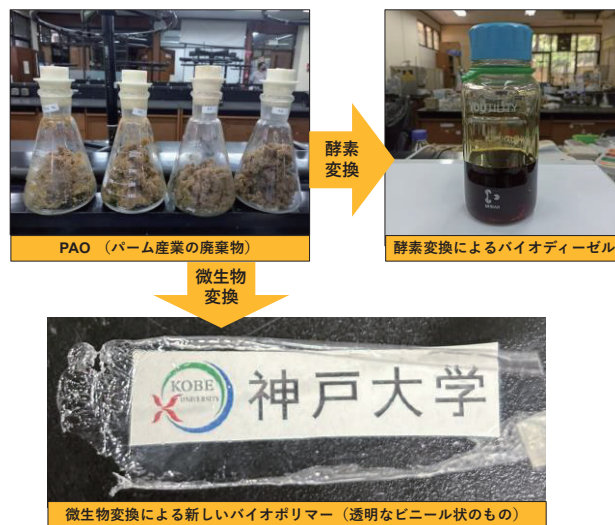
図 331-18 : 農業残渣を有効利用した燃料や化学品への変換 (インドネシア)
