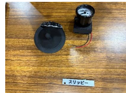
写真：加速度センサ付きスピード抑制機 (札幌市立明園中学校提供)
