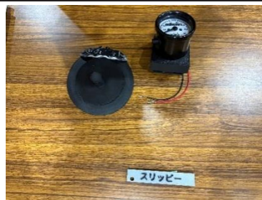
図2：加速度センサ付きスピード抑制機
