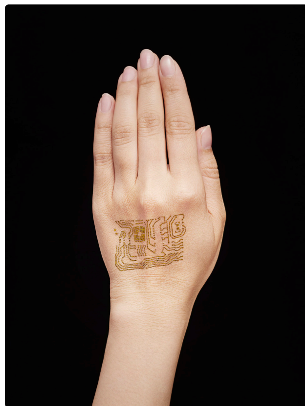
第4世代のデバイスには通気性を持たせているため、貼り続けても長期間生体の情報を計測可能になった。
