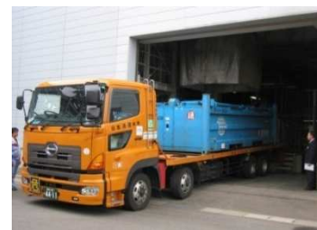
オープントップコンテナ容器 使用による汚泥輸送
