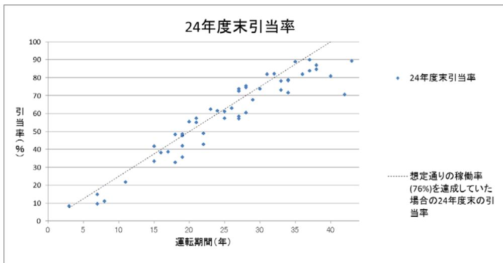
(注)想定とおりに設備利用率が76%で40年間運転する場合の引当率を点線で示しており、点線より上側にプロットされているものは想定を上回るペースで、下側にプロットされているものは想定を下回るペースで引き当てられていることを表している。
