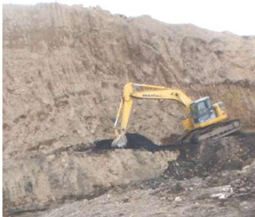
※海外の炭鉱と比較して、極めて薄い複数の炭層(50cm~2m程度)を採掘している。
