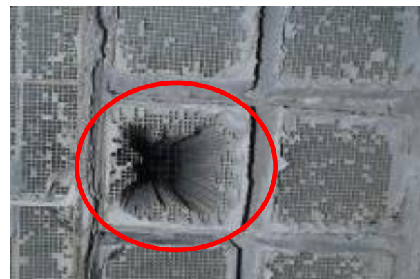
②脱硝触媒一部損傷状況
