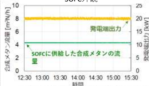
合成メタン流量と発電機出力 SOFC(20kW級)による発電確認
