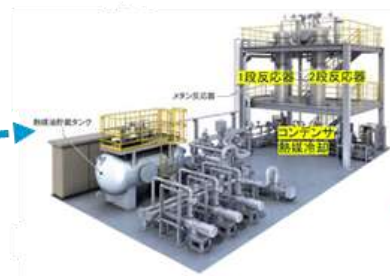
メタネーション設備
