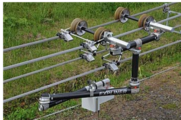
超高圧架空送電線点検ロボット「Expliner」
