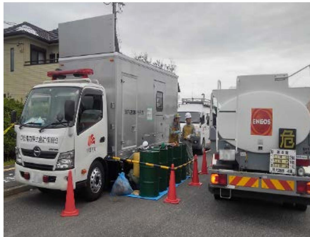
電源車への燃料補給の様子
