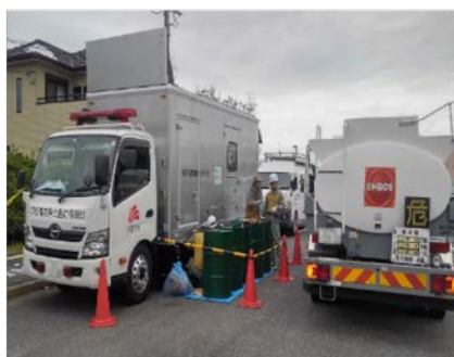
【図 35】 タンクローリーから電源車への燃料補給の様子（左）
