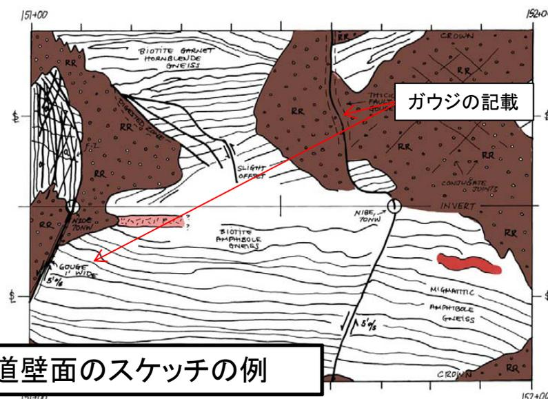
坑道壁面のスケッチの例
