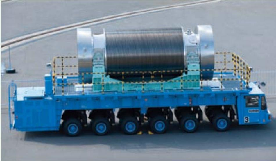
**使用済燃料・高レベル放射性廃棄物輸送車両**は、自走式で連結部がなく、48輪の車輪で走行します。積載する輸送物が100トンを超える重量となるため、走行安定性に優れた設計となっています。予備の安全ブレーキ、助手席に緊急停止ボタンを備え、万が一の際も車両を安全に停止させることができます。
