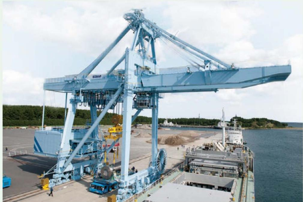
**150トン橋形クレーン**は、使用済燃料、高レベル放射性廃棄物を荷揚げするためのクレーンです。重量が100トンを超えることもある輸送容器を確実に荷役する吊り能力を備えています。また、モーターや電源を二重化（非常用電源も配備）し、停電時でも吊り荷を確実に降ろします。
