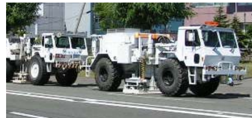
陸上の反射法探査の 大型バイブレータ震源
