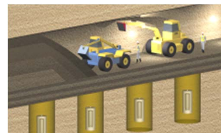
7. 処分坑道の埋め戻し
