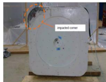
落下試験を経た 大型角型処分容器
