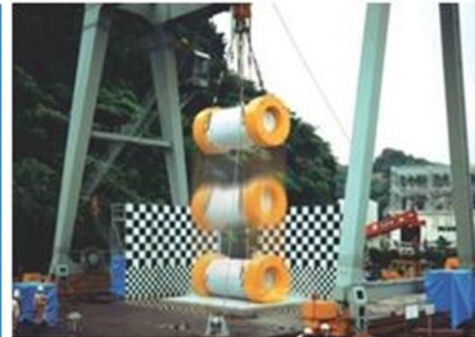
専用容器の落下試験
