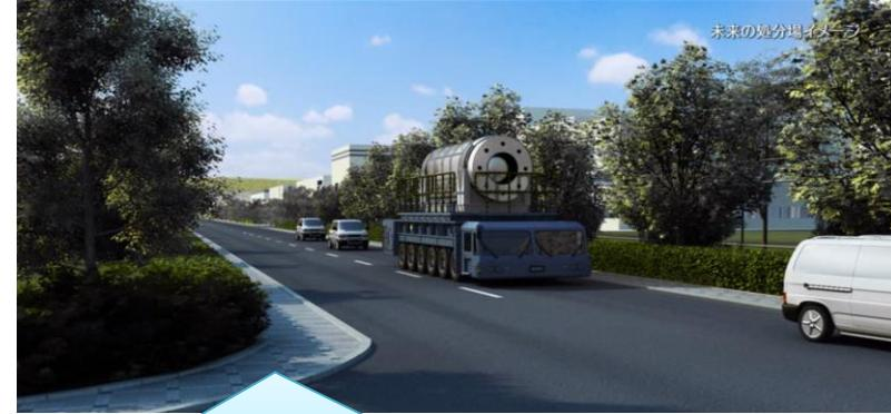
ガラス固化体を入れた専用容器（総重量100トン規模）を運ぶトレーラーが走る道路を整備
