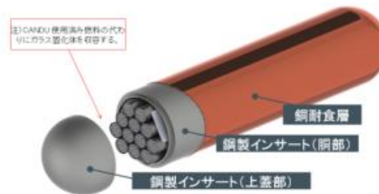
銅-炭素鋼複合オーバーパックの製作技術の開発（NWMOとの共同研究）
