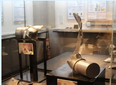
配管破断事故（実物）
