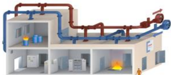
油火災、ケーブル火災の伝播試験等の実施 (OECD/PRISME-2プロジェクト)
