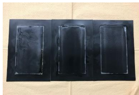
試作した自己修復性ハイブリッド積層材料
