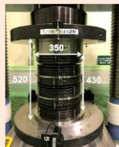
3次元免震装置／皿ばね試験体
