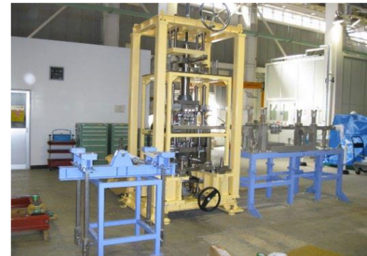
遠隔保守向けペレット成型設備のモジュール交換モックアップ試験
