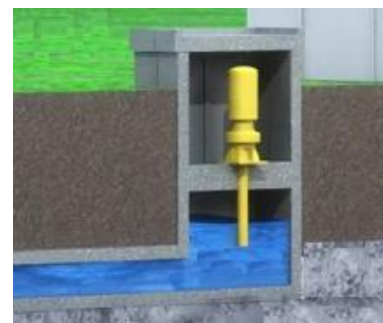
別置き海水ポンプ (常用海水ポンプとは別の場所に設置)
