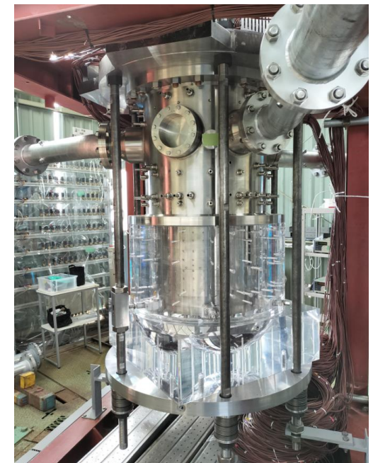
下部プレナム流動試験の供試体 (左図の青色領域が対象)
