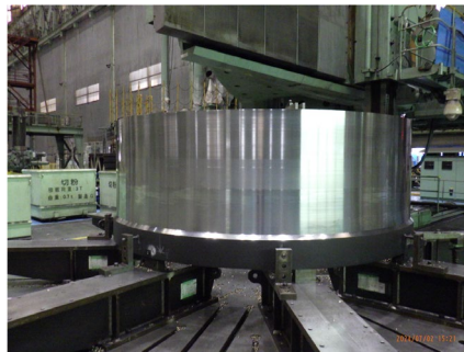
格納容器 （実規模ステンレス鍛造材）
