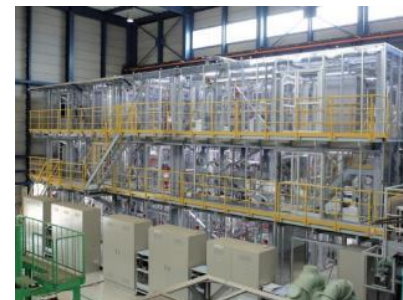
連続水素製造試験装置 (0.1 m 3 /h)
