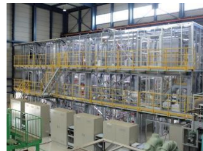
連続水素製造試験装置 (0.1 m 3 /h)
