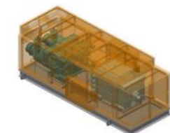
常設代替非常用電源 (ガスタービン発電機)
