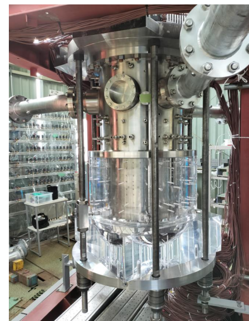
下部プレナム流動試験の供試体 (左図の青色領域が対象)
