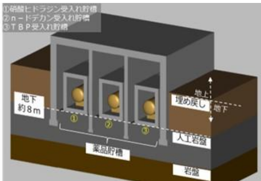
薬品貯槽 地下移設後イメージ
