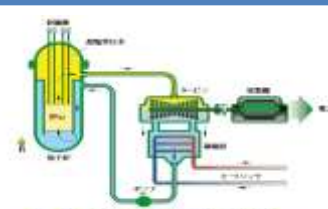
図3 第4世代原子炉概念(1) 超臨界圧水冷却炉
