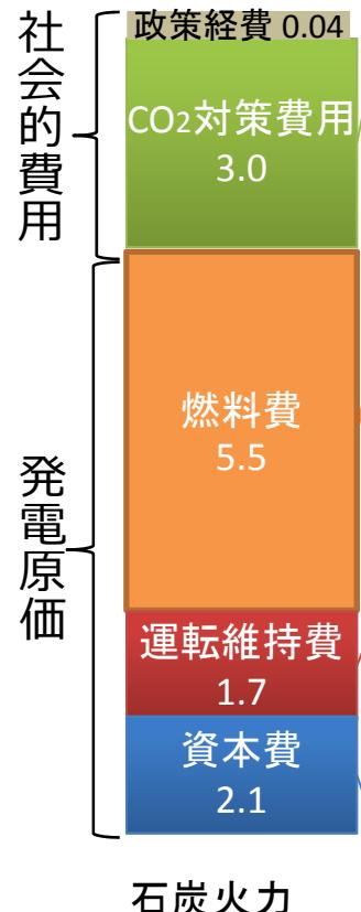
※モデルプラントとして、設備容量80万kW、設備利用率70%、稼働年数40年のプラントを想定
