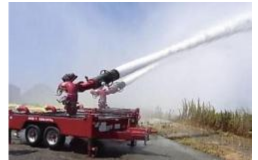
【屋外放水設備】
