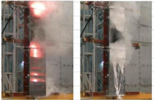
ケーブル火災時の自動消火設備消火性能試験
