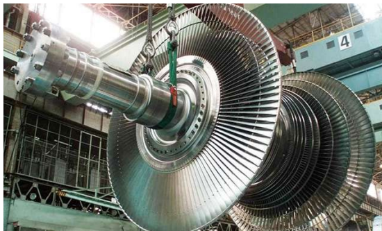
(54インチ低圧タービンロータ)
