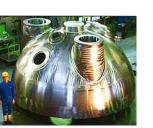
原子炉圧力容器部材 (日本製鋼所M&E)
